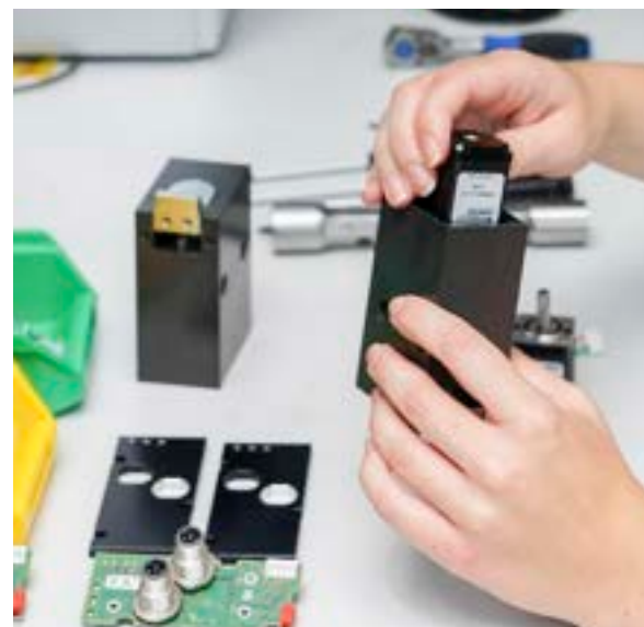
Assemblage des séparateurs électriques
